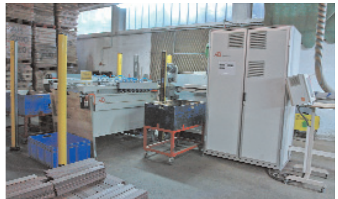
Geringer Platzbedarf: Sortierlinie für Lamellen mit Farbscanner Argus Spectra und folgender Abstapelungs-Mechanisierung TransSort
