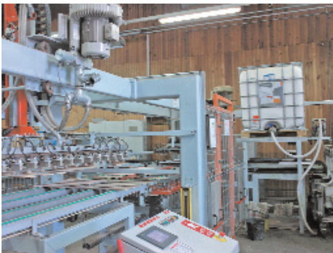
Lamellen (v. li.) werden automatisch auf das Trägermaterial aus HDF- oder Sperrholzplatten (v. re.) aufgelegt und anschließend verpresst
