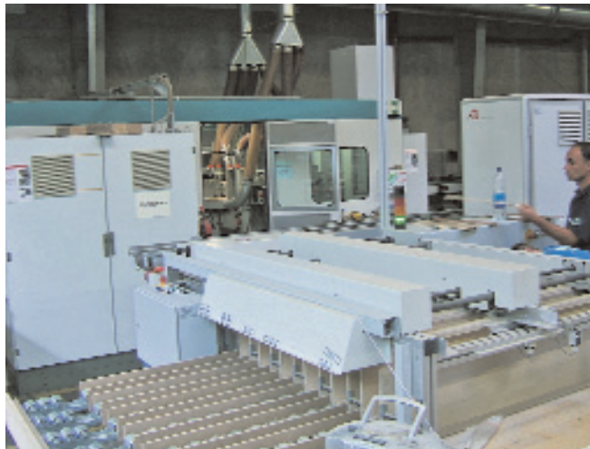
Lackierte und profilierte Fertigparkett-Elemente werden mittels ATB-Endkontrolle hinsichtlich Oberflächendefekte begutachtet
