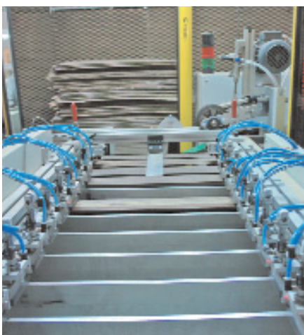
Nach der Qualitätssortierung durch den Farbscanner werden die Lamellen mit bis zu 530 Stück pro Minute abgestapelt
