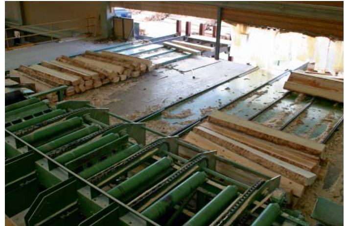
Durch den ATB-Scanner wird in gute, weiße Qualität und Palettenware sortiert, um die Wertschöpfung zu erhöhen
