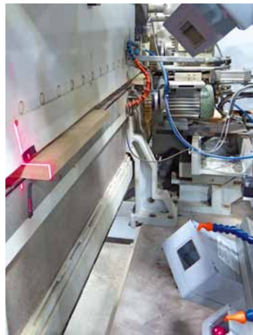
Laser, Helligkeit und Reflexion verraten, ob die Kante den strengen Vorgaben entspricht
