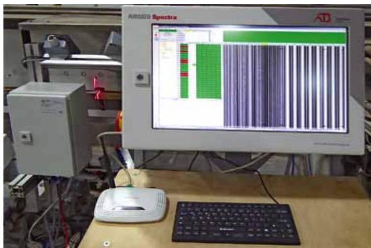
Laser, Helligkeit und Reflexion verraten, ob die Kante den strengen Vorgaben entspricht
